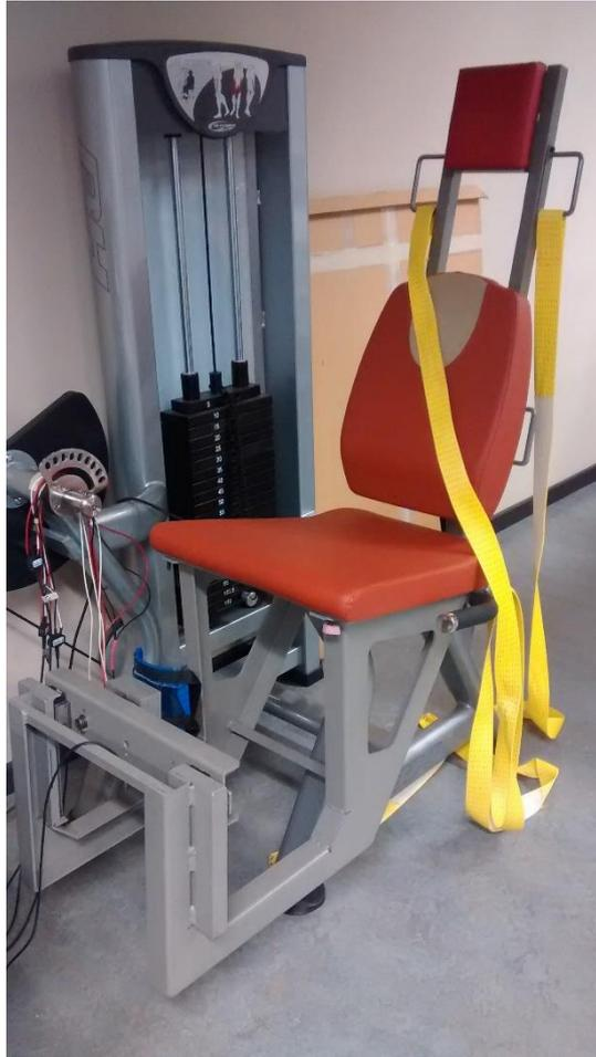
Figura 16 - Máquina de extensión de cuádriceps modificada.
